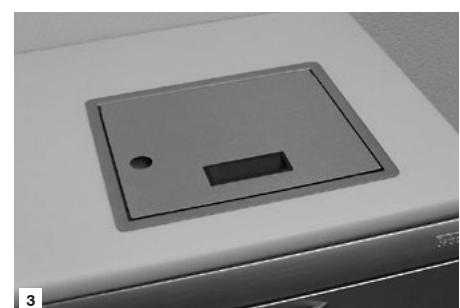
**1** Interrupteur principal de l'appareil toujours sur „ON“. L'appareil est mis en marche à l'aide de l'interrupteur principal situé sur le couvercle de la table [1].
