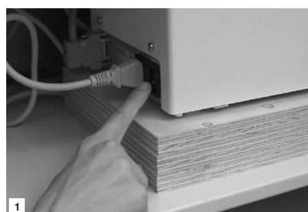
**1** Gerätetreiberschalter immer auf "ON". Gerät wird mit Hauptschalter auf Tischabdeckung [1] eingeschaltet.
