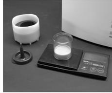
Den Mischbehälter auf die Präzisionswaage stellen und die Tara auf Null stellen.
