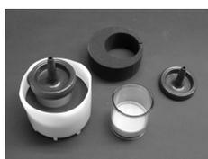
Damit der handelsübliche Becher in das Gerät eingesetzt werden kann, wird in einen Mischbecher gross der Becher-Einsatz zum handelsüblichen Becher eingesetzt. Der handelsübliche Becher wird in den Becher mit Einsatz eingefügt und als Ganzes in den Becherträger des Gerätes zum Mischen eingesetzt.
