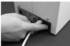
Das Gerät hat auf der Geräterückseite einen Hauptschalter zur Unterbrechung der elektrischen Spannung.
