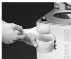
Den Mischbecher aus dem Gerät nehmen und den Deckel mit leichter Drehung öffnen. Das Alginat mit dem Spatel aus dem Mischbecher entnehmen.
