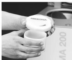
Den Deckel auf den Mischbecher aufsetzen und mit einer Drehung sichern. Sicherstellen, dass der Mischbecher richtig verschlossen ist.
