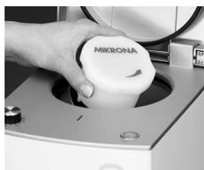
Den Mischbecher in das Gerät einsetzen und den Deckel des Gerätes schliessen.
