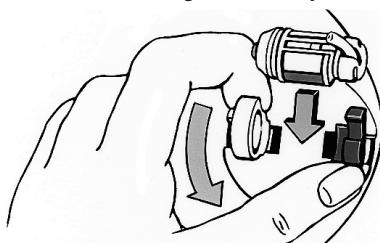
Levantar a tampa de protecção do RotoMix. Abrir o contentor de cápsulas, girando-o no sentido inverso ao dos ponteiros do relógio. Colocar a cápsula activada com a abertura de descarga na metade azul do contentor de cápsulas e largá-lo. O contentor fecha-se automaticamente.
