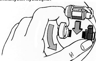
Nosta RotoMixin suojakansi pystyn. Avaa kapselinpidin kiertämällä sitä vastapäivään. Aseta aktivoitu kapseli, poistoaukko kapselinpitimen sinisessä puoliskossa, paikalleen pitimeen ja päästä kapselinpidin. Pidin sulkeutuu automaattisesti.
