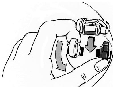
Den Schutzdeckel des RotoMix nach oben aufklappen. Den Kapselhalter durch Drehen gegen den Uhrzeigersinn öffnen. Die aktivierte Kapsel mit der Auslassöffnung in der blauen Hälfte des Kapselhalters einlegen und den Kapselhalter loslassen. Der Halter schließt selbsttätig.
