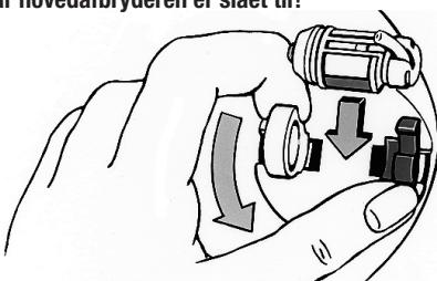
Klap RotoMix'ens beskyttelsesdæksel op. Åbn kapselholderen ved at dreje mod uret. Indsæt den aktiverede kapsel med udløbsåbningen i kapselholderens blå halvdel, og slip kapselholderen. Holderen lukkes automatisk.
