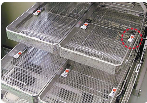
Placez le test de lavage dans le panier (Positionnement recommandé illustré sur la photo)
