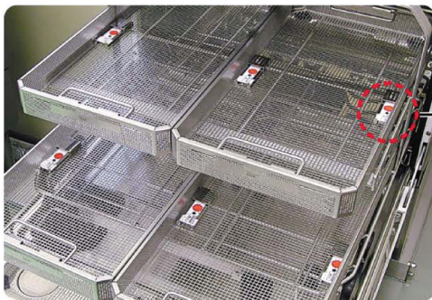
Einlegen des Waschtests in den Korb (Empfohlene Platzierung wie in der Abbildung gezeigt)
