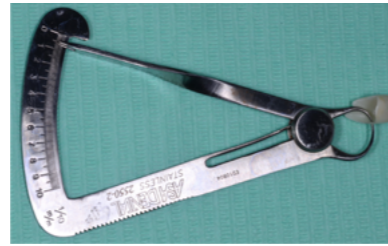
Mesio-distale Wandstärke: 0,5 mm
