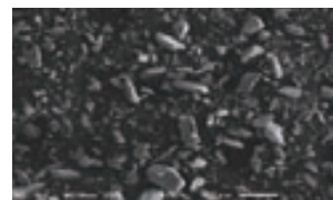
Perio-Mate Powder (Glycin): durchschnittliche Partikelgröße etwa 25 µm, SEM-Aufnahme (x150)
