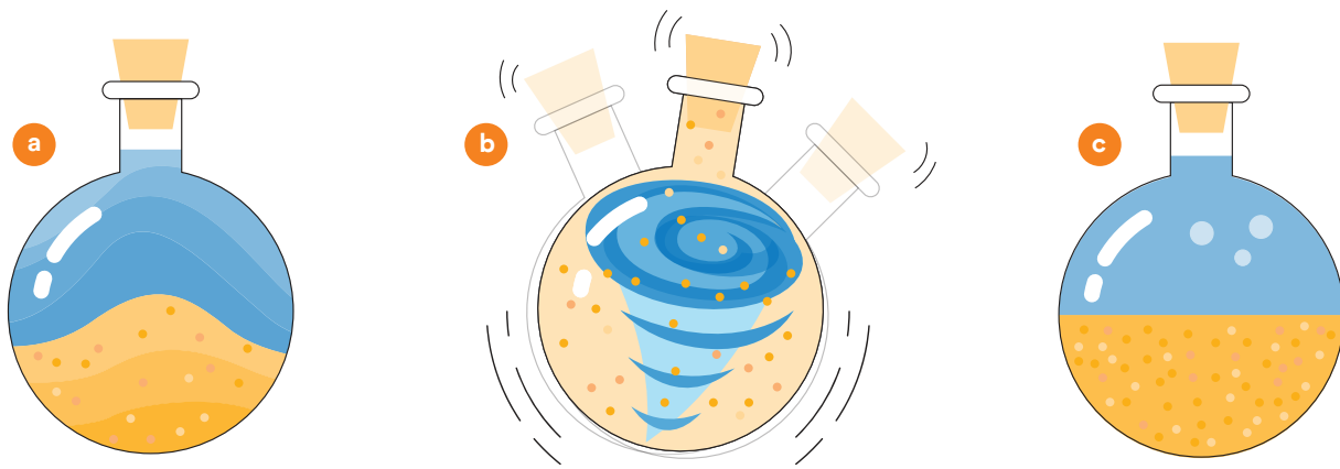
Abbildung 3: Das Verhalten von Sand in Wasser: a) stockender Sand und Wasser in einer Flasche; b) Sand und Wasser unmittelbar nach kräftigem Schütteln der Flasche; c) Situation nach einigen Sekunden, wenn der Sand sich auf dem Boden absetzt.
