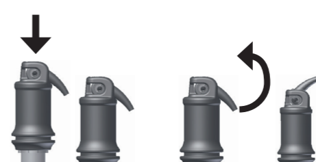
Abb. 1: Aktivieren der Kapsel
