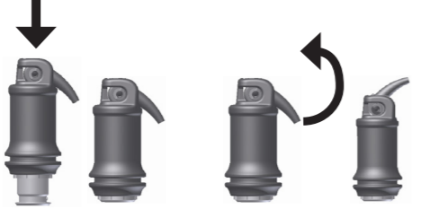
Fig. 1: Ativação de cápsula
