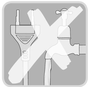
Wasserzufuhr schließen und Spannungsversorgung des Endgerätes abschalten.
