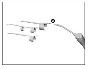
Blasen Sie mit Druckluft das Kühlmittelrohr und die Austrittsöffnungen frei.
