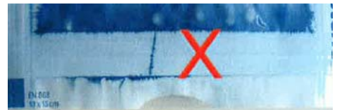
Abb. 3: Negativtest. Prüflösung durchdringt die Siegelnaht.
