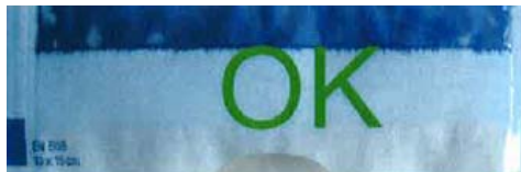
Abb. 2: Positivtest. Keine Durchdringung der Siegelnaht durch die Prüflösung.
