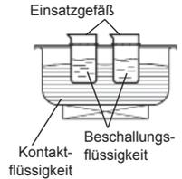
Für die indirekte Beschallung muss zwischen Einsatzgefäß und Schwingwanne zwingend eine Kontaktflüssigkeit (Wasser + tensidhaltige Präparate) eingefüllt werden.
