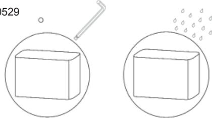
Geschützt gegen den Zugang zu gefährlichen Teilen mit Werkzeugen, Geschützt gegen feste Fremdkörper 2,5 mm Durchmesser und größer
