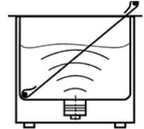
6. Schalten Sie den Ultraschall aus. Nehmen Sie den Folienteststrahlen heraus. Nehmen Sie die Aluminiumfolie vom Folienteststrahlen ab und lassen Sie sie trocknen.
